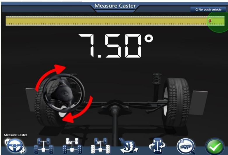
Abbildung 3.2.3-2 das Lenkrad nach rechts drehen
