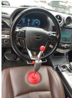
*Abbildung 2.4 Einbau des Lenkradhalters*
