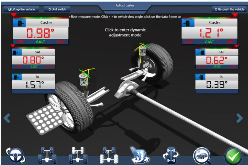
Abbildung 3.2.3-5 Messung des Nachlaufergebnisses
