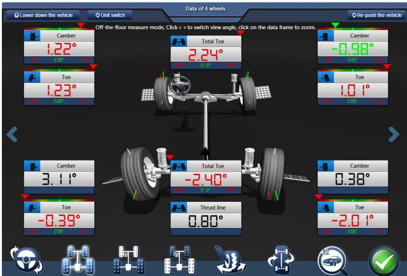
Abbildung 3.4-3 Daten von 4 Rädern im Messmodus "Außerhalb des Bodens"
