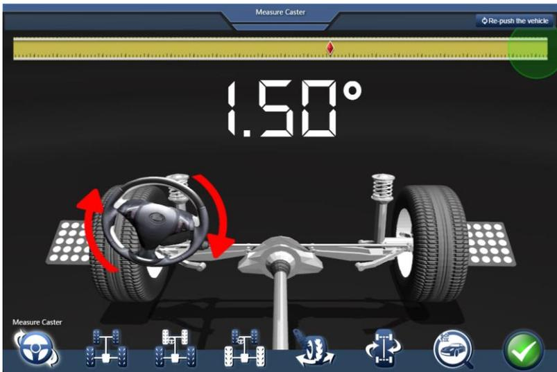
Abbildung 3.2.3-1 Messen Sie die Schnittstelle zum Nachlauf
