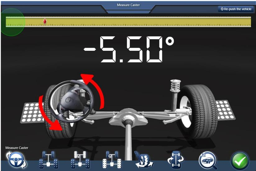
*Abbildung 3.2.3-3 Drehen Sie das Lenkrad nach links*
